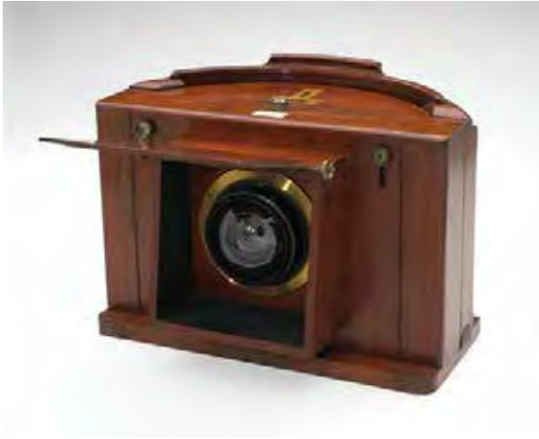
Museum Victoria, Australia. Câmara panorâmica de plano curvo e objetiva com água destilada.
