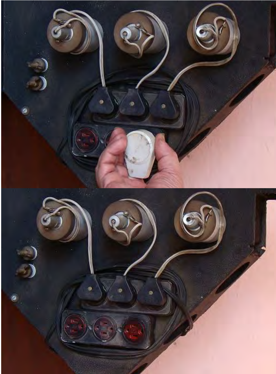
Detalhes onde observamos a tomada do setor e os parafusos, para contato na bateria de 12V.
