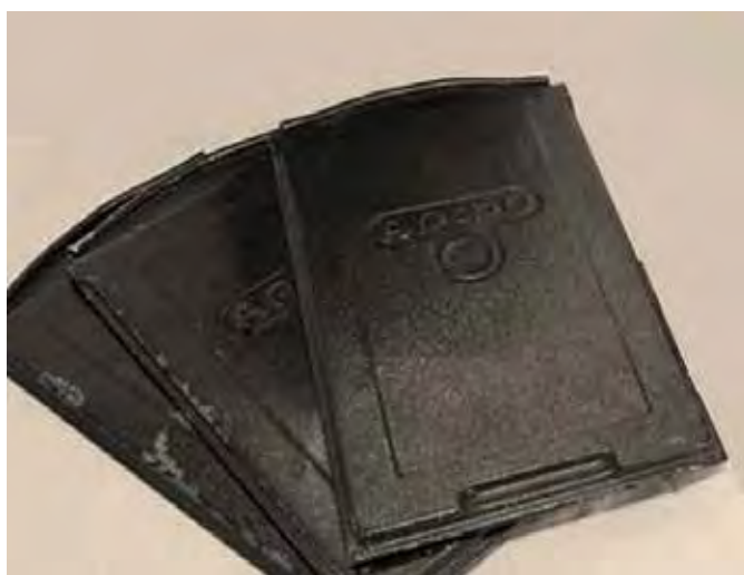
Três chassis metálicos simples para 6,5x9cm.
