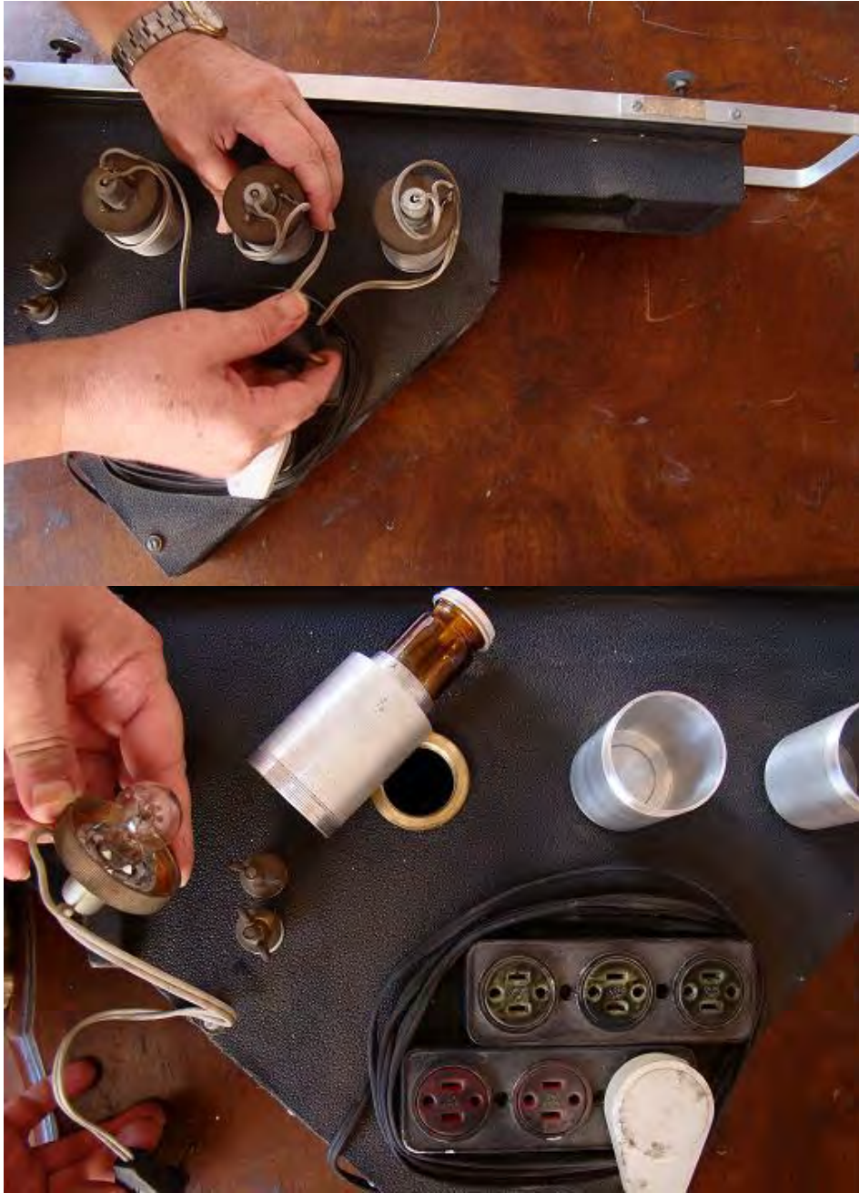
Demonstração das câmaras de fumação com aquecimento por lâmpada de automóvel de 12V, e frasco inderramável que penetra nas mesmas. O equipamento pode funcionar com bateria de 12V ou pelo transformador embutido 127/220V AC.
