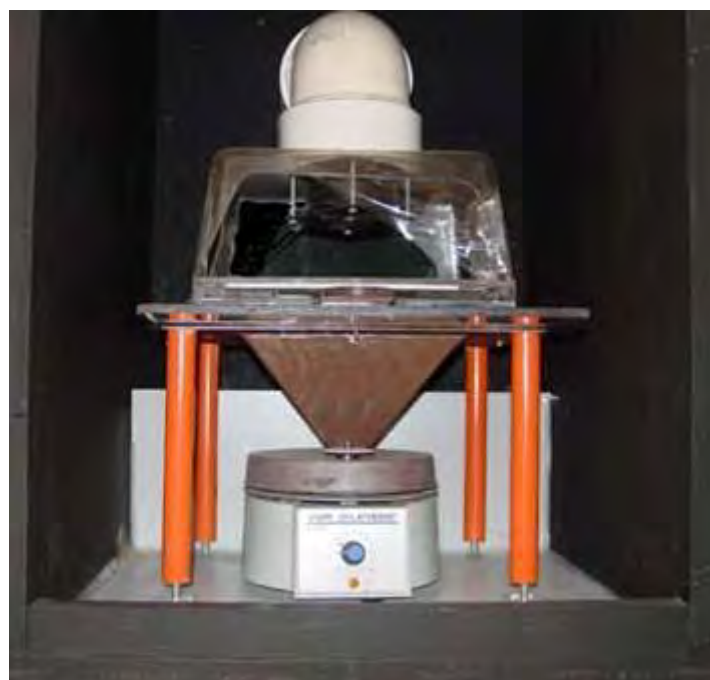
Sistema de revelação com mercúrio empregado por Schreiner utilizando aquecedor controlado e realizado em capela de laboratório.
