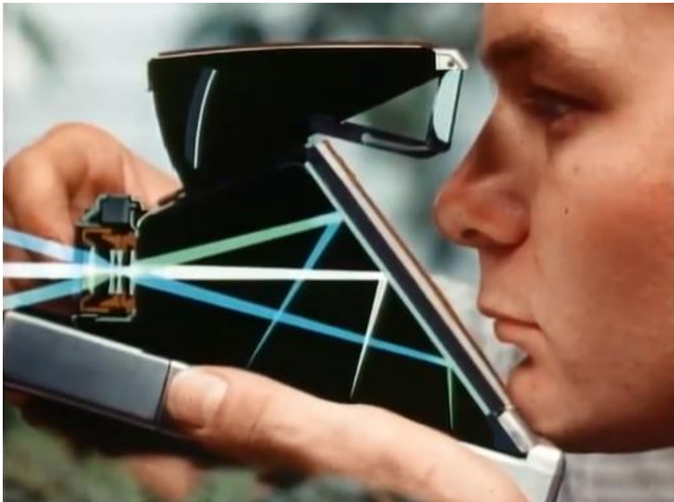
Esquema de raios luminosos na Polaroid SX70 durante a visão(acima) e durante a exposição(abaixo).
