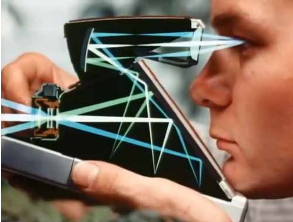
Esquema de raios luminosos na Polaroid SX70 durante a visão(acima) e durante a exposição(abaixo).
