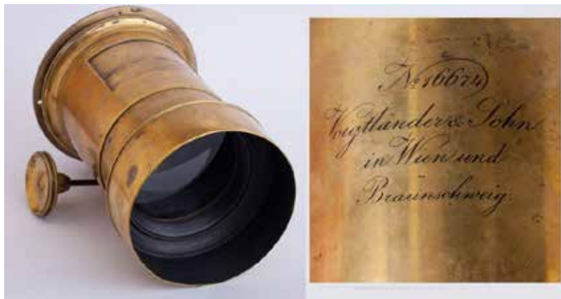
Objetiva Petzval original de Voigtländer f/3.7 produzida em 1864 e esquema da "Voigtländer's Apparat zur Erzeugung photographischer Porträte," (Aparelho Metálico de Voigtländer para retratos)
