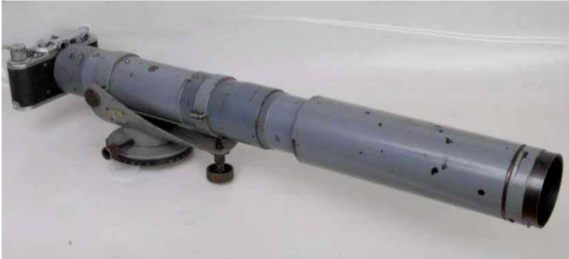
Objetiva "DF" 1400mm como tele concebida para observação e fotografia das movimentações nas costas da Finlândia.
