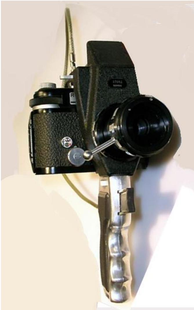
Robot Star II Vollautomat com caixa reflex storz para endoscopia e pistola de segurança.
