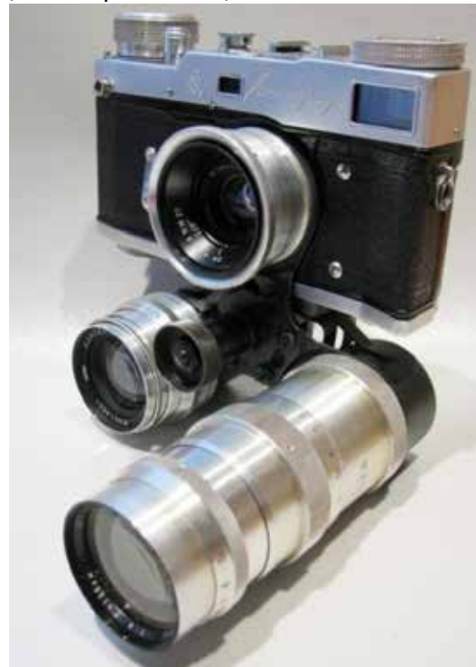
Câmara Leningrad para reportagem com três objetivas Jupiter 8 f2/50; Jupiter 12 f2.8/35 e Jupiter 11 f4/135
