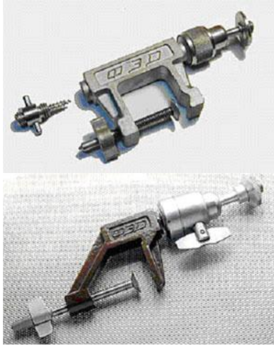
Sargentos de dois tipos para segurança das câmaras e dois tipos de tripé de mesa.
