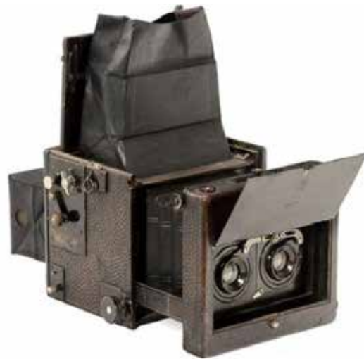
Ernemann Reflex Camera 1907-1918. Em versões 6.5x9, 8x10.5, 9x9, 9x12, 12x16.5cm e Estéreo em 10x15 cm. Corpo em madeira revestido com couro e fole de dupla extensão.
