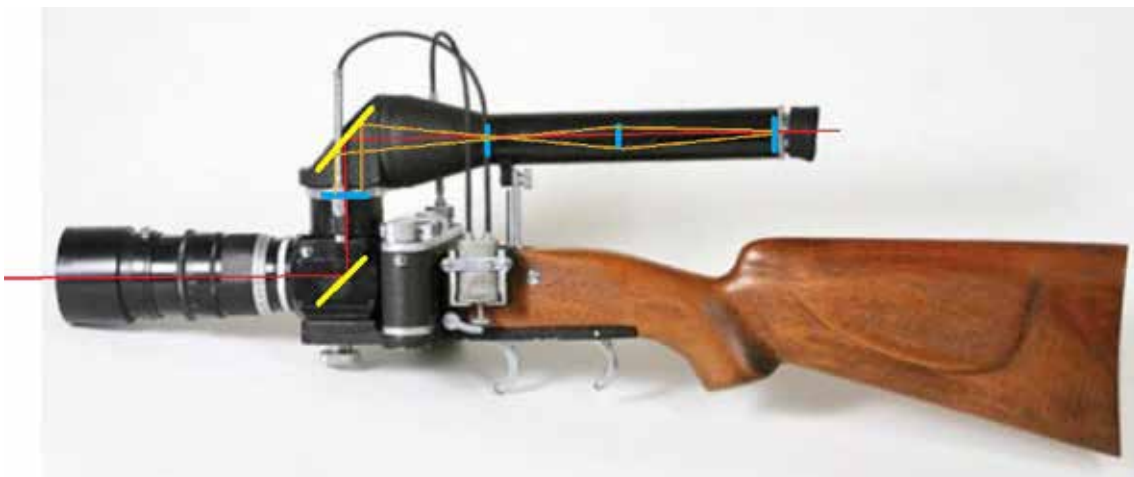
Leica Sistema Ploot. Leica Sniper New York. A correção do posicionamento da imagem é feita no tubo de observação através da lente Dollond usada no telescópio astronômico (1933)
