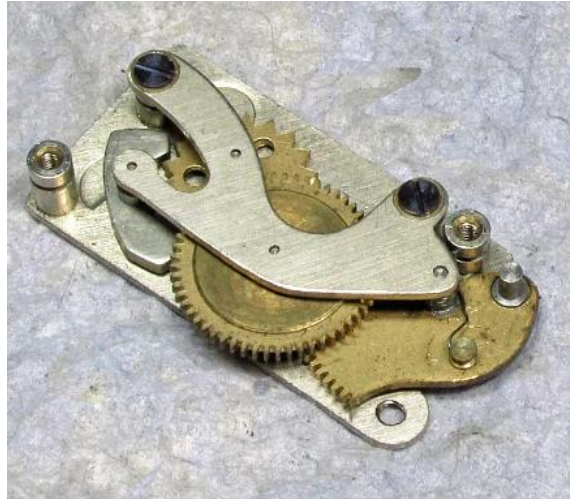
Baixas velocidades Leica IIIa produzido pela empresa alemã Gauthier Prontor
