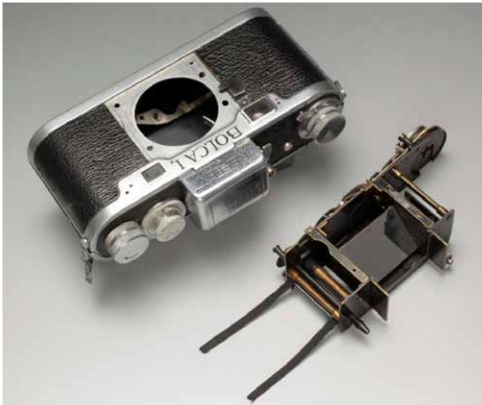
Bolca I com telêmetro e visor conjugados e visor reflex
