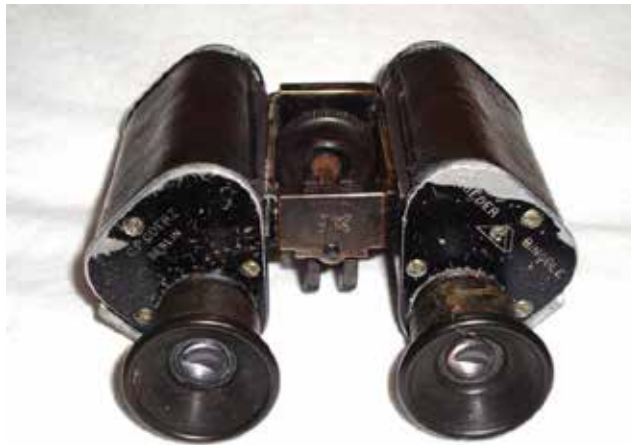
Binóculo Goerz de 1894 utilizando princípio de Porro
