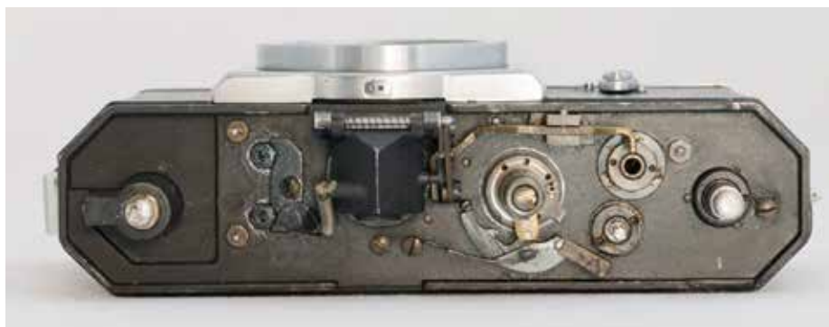
Ucaflex –parte interior onde se vê o prisma diminuto
