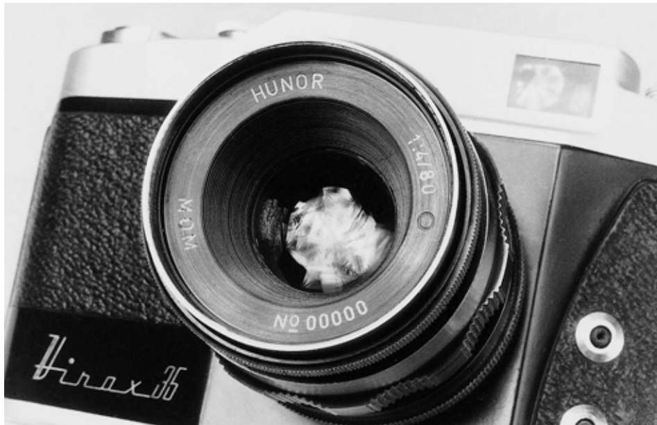
Virax 35. (telêmetro). Protótipo. Montagem compatível com Virax 35 P. Objativa Hunor 4/80mm (1959)
