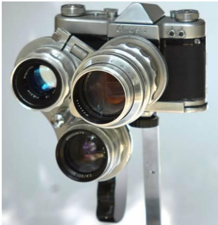
Protótipo de Start com torre de objetivas
