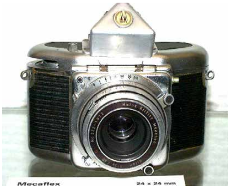
A Mecaflash com pentaprismo exige a substituição da tampa superior, que possui um corte para a alavanca de rápido avanço do filme.
