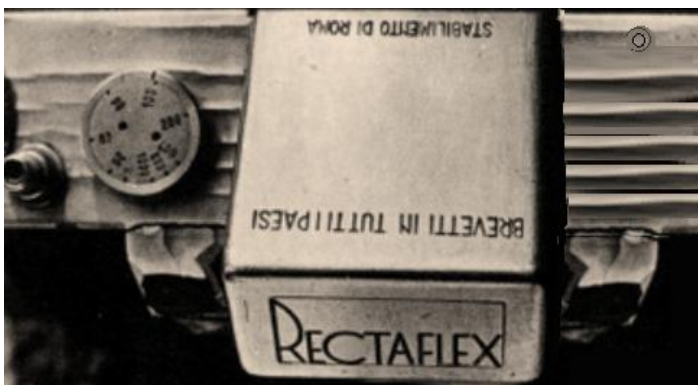
Tipo 47 - primeira série. Não possuía sistema de rebobinamento nem baixas velocidades. A segunda série já tinha configuração tradicional.
