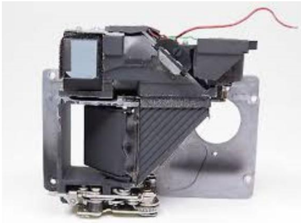
Disposição dos componentes do visor e módulo óptico da Olympus Pen F
