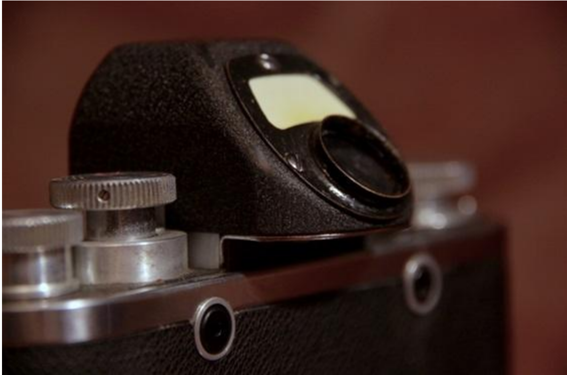
Alpa Prisma Reflex com prisma de Kern permitindo visualização a 45°
