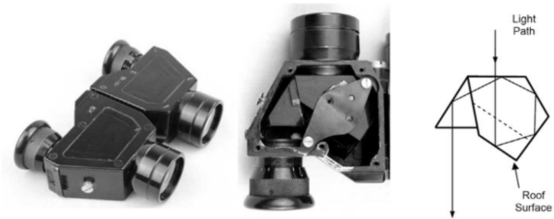
Binóculo prisático de Möller (Tourox 8X; J.D. Möller, Wedel, Germany, anos 1920). A ereção é realizada por dois prismas colados e seguros por garras. Temos no arranjo seis reflexões.
