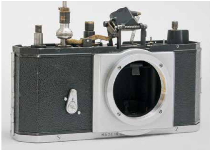
4º estágio: Prisma e Espelho suspensos. Caminho livre para o visor de Newton.
