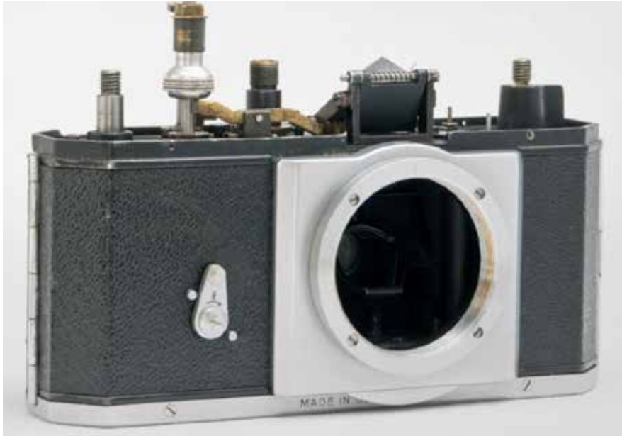
1º estágio: Prisma e Espelho em posição de descanso
