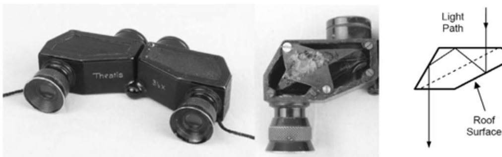
Binóculo com prisma de Leman Theathis 3 ½ X fabricado por J. D. Möller Germany 1920 Roof Surface = Face em Teto
