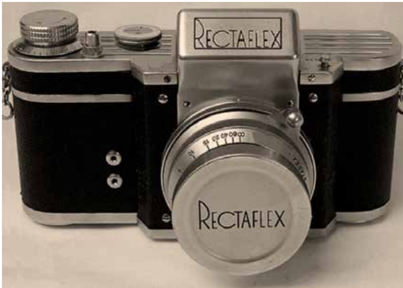
Tipo 47 - primeira série. Não possuía sistema de rebobinamento nem baixas velocidades. A segunda série já tinha configuração tradicional.
