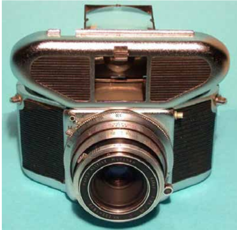
Mecaflex com janela do visor aberta para uso como visor esportivo.
