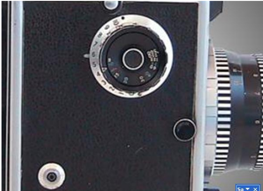
Detalhe do comando de velocidades e do anel de sincronismo.
