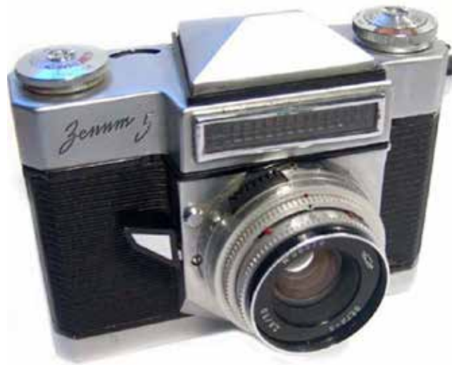
Zenit 5 -A única SLR com obturador central com motor drive
