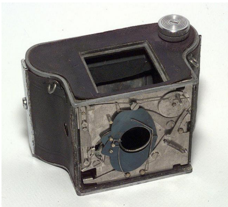
Sistema mecânico da Babyflex/Superflex idêntico à Karmaflex (duas imagens).
