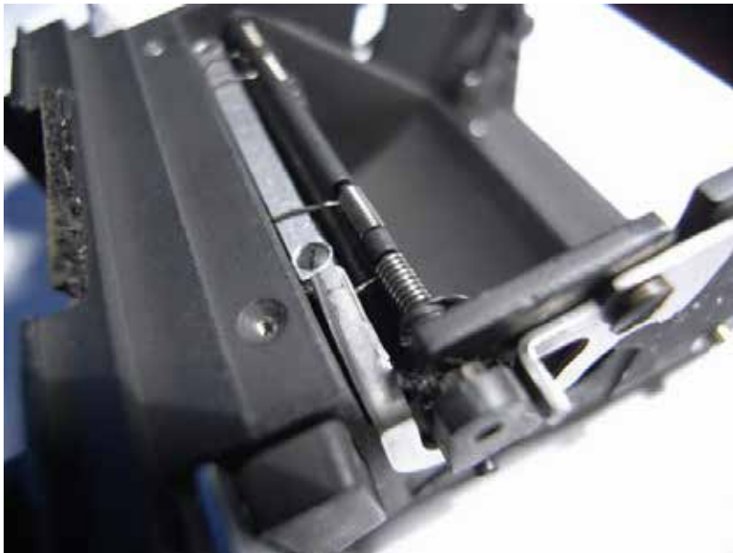
Imagens do obturador Exa 1/25 à 1/150 e B sincro M e X
