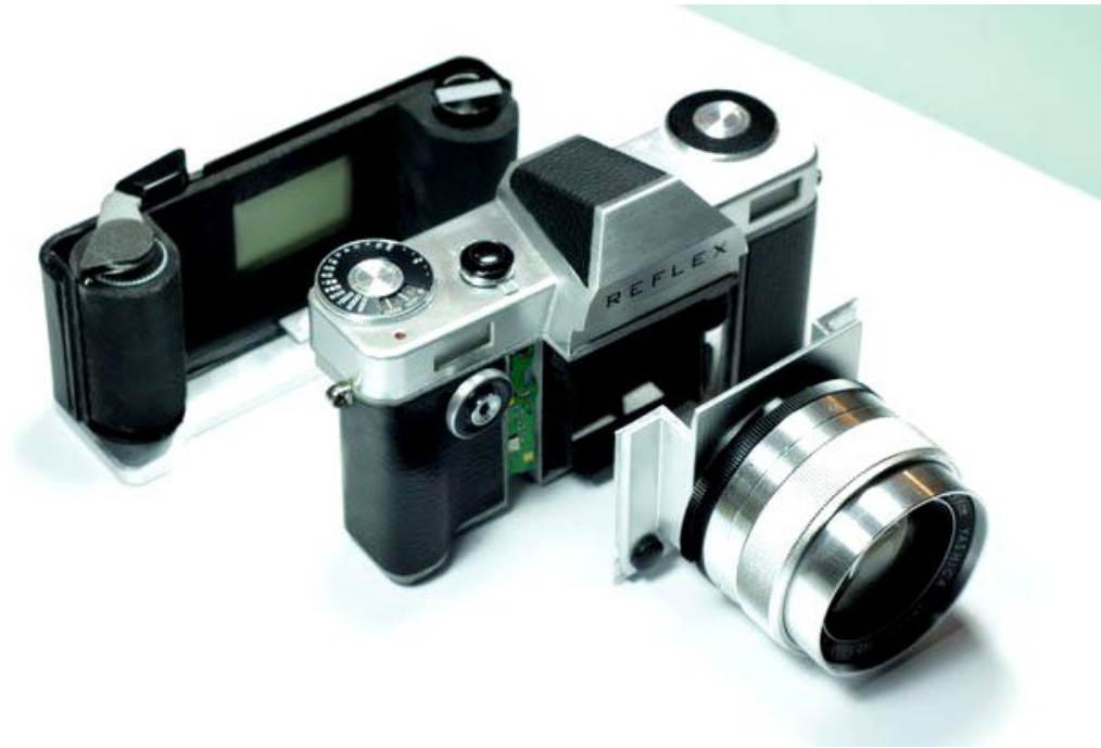
Construção modular com cambiabilidade do porta objetivas frontal
