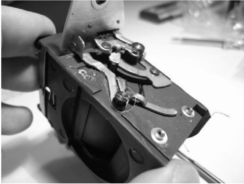
Imagens do obturador Exa 1/25 à 1/150 e B sincro M e X
