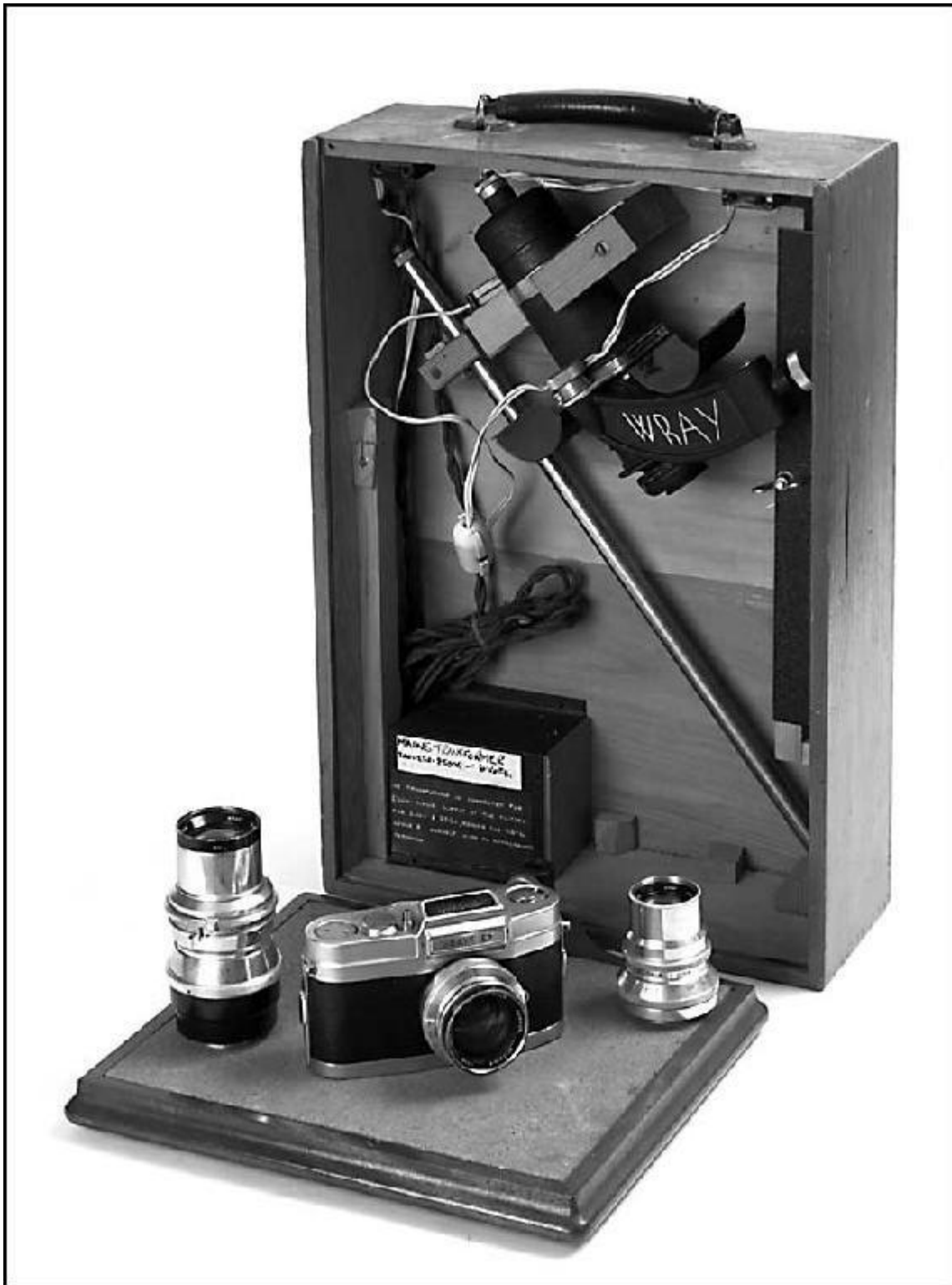
Raro conjunto fotográfico Wray que foi comercializado nos promórdios do lançamento da câmara: Uma Wrayflex modelo Ia, three Wray três objetivas 2/50, 4/90, 4/135 e ampliador original com transformador para lâmpada de baixa voltagem.
