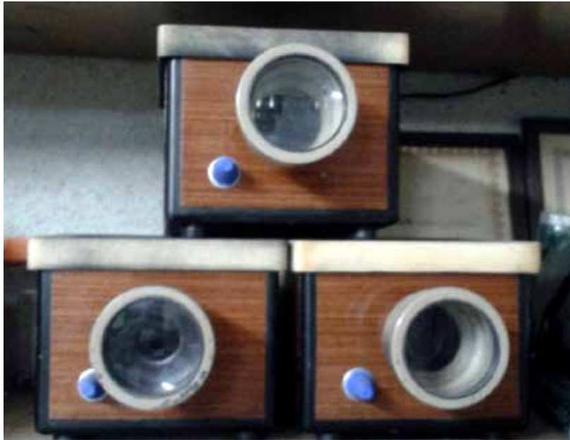
Primeiras câmaras produzidas após a cooperação, e imagem produzida pelas mesmas. O botão azul comanda a abertura e fechamento da passagem de luz.
