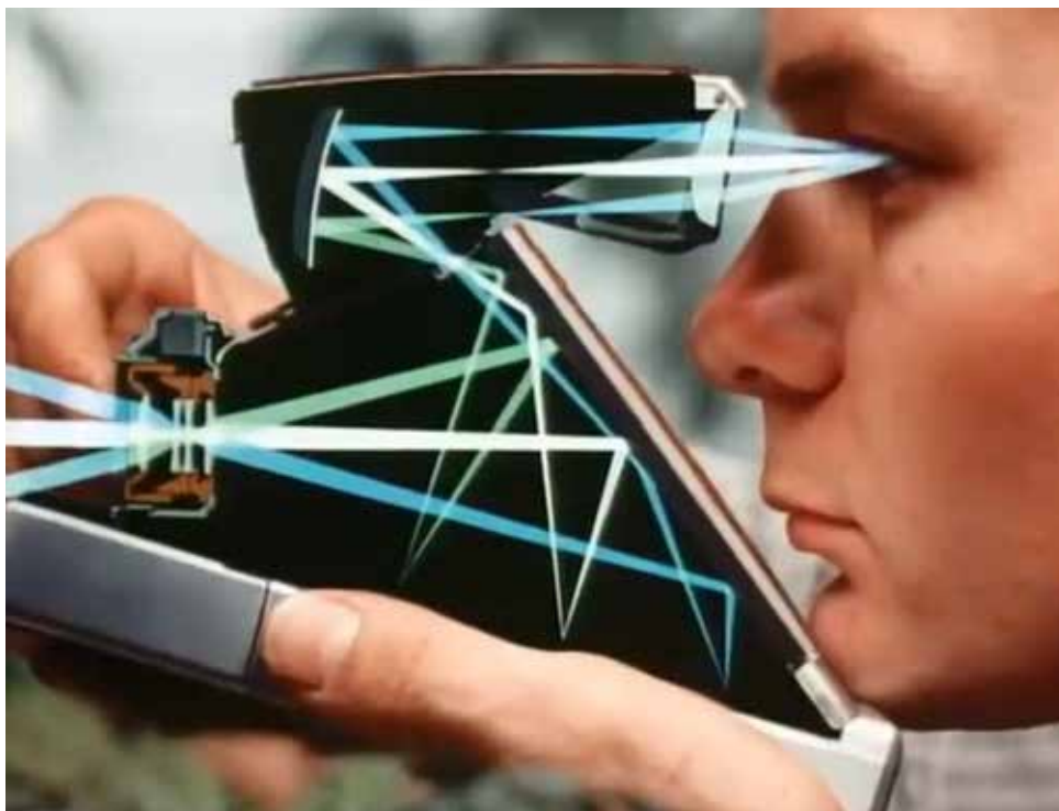
Esquema de raios luminosos na Polaroid SX70 durante a visão(acima) e durante a exposição(abaixo).
