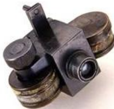
Uranus 2 -b O movimento do visor põe em operação a abertura do obturador.
