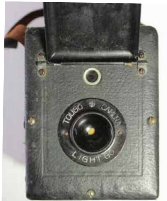
A Tougo-Light-Go Camera é uma Yen camera como as outras com falsa aparência de uma mono reflex, com vemos no detalhe acima, com o visor disfarçado.
