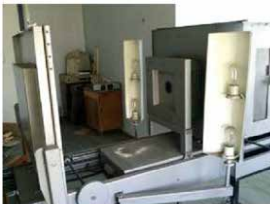
Aparelho de eletrofotografia semi automatizada EP12R2 produzido pela Fabrica experimental de Kaunas.
