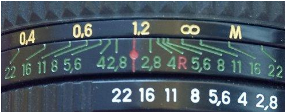
Escala de foco da objetiva Zenitar. Distancias para fotografar na região do IR devem ser lidas em relação ao R.
