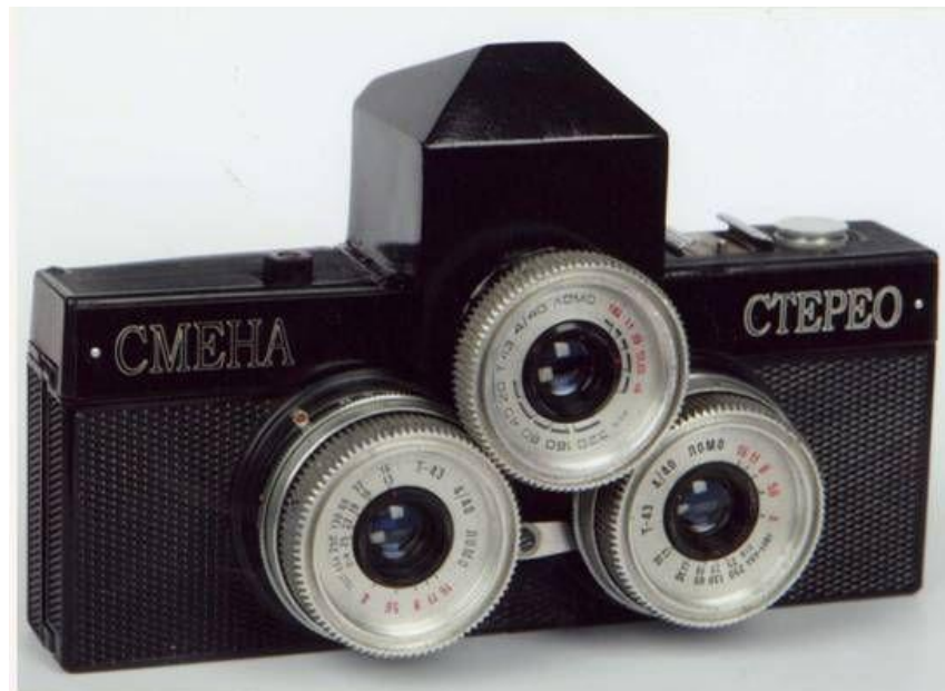
Proposta de Sergei Suglob três objetivas de Smena e pentaprisma de Zenit Obturador de Sputnik modificado.
