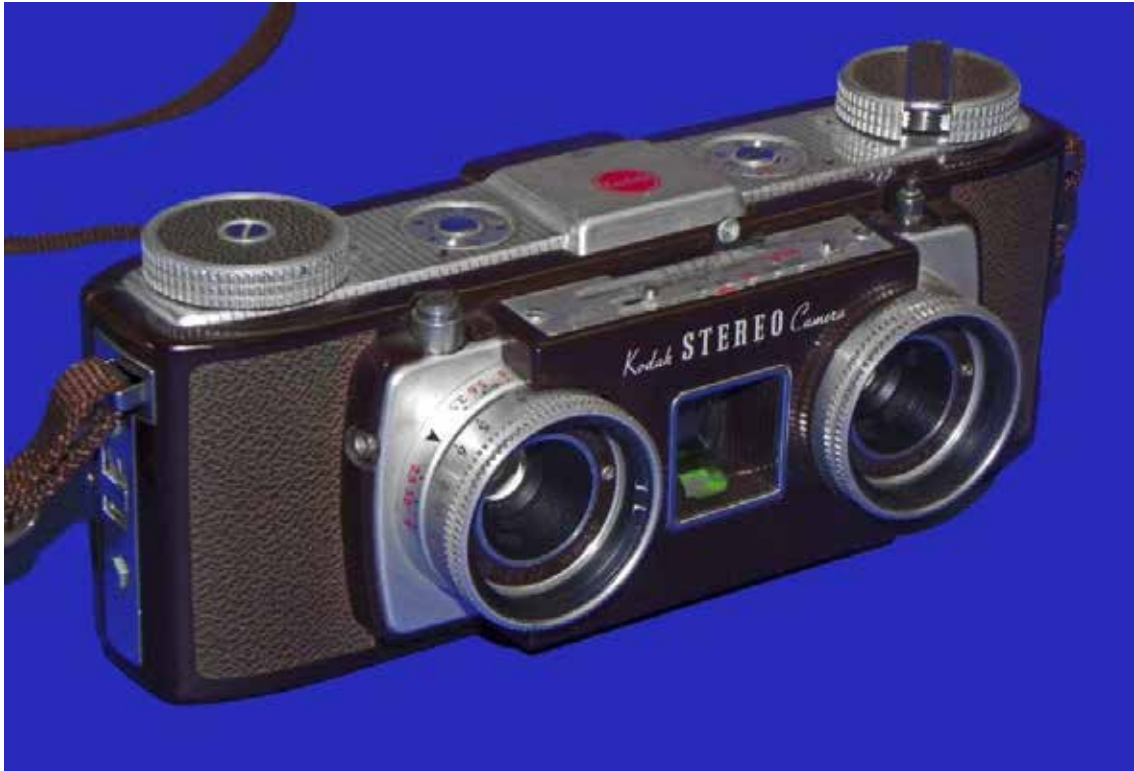
A Kodak Stereo, único modelo estereoscópico do pós guerra da Kodak o projeto era sensivelmente baseado na Realist, utilizando-se de uma construção mais barata.
