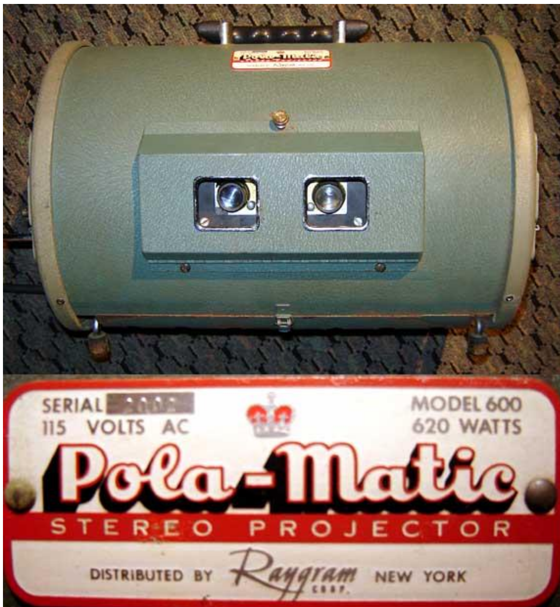
Projeto Polamatic destinado para aulas em igrejas etc. possui tambor de slides para projeção de sequencias estereoscópicas.
