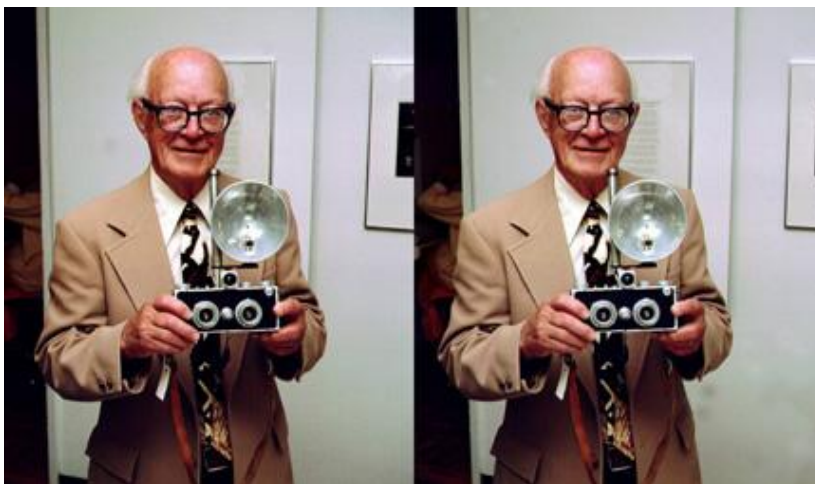
Seton Rochwite com seu primeiro protótipo funcional a partir de duas Argus C3. Na foto com um flash Kalart. (foto de David Hutchison )
