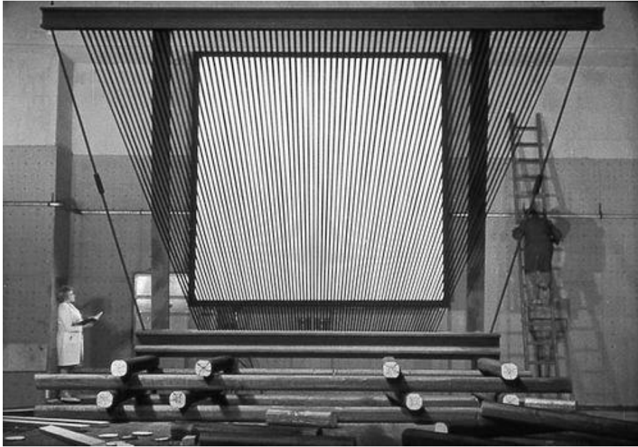
Sala experimental "Art" de Moscou para o filme " Um dia em Moscou" (realizado por Alexander Ptouchko) Tela de projeção com grade de barreira descoberta.
