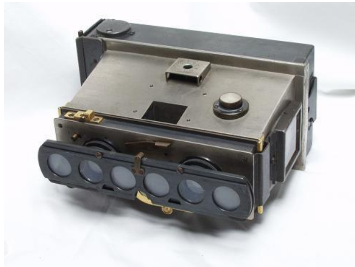
Verascope Richard adaptado com bonettes (filtros e lentes de aproximação)
