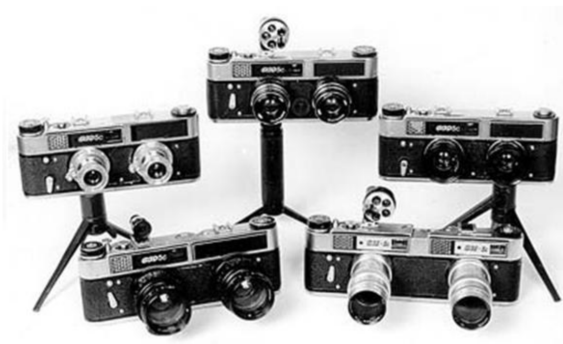
Na base FED5 com 65mm, 75mm 94mm e 112mm de base estéreo
