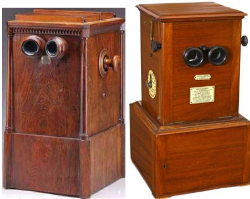
Esquerda: estereoscópio de mesa em roseira; Beckers, Stereopticon, para dois espectadores frente a frente –avanço automático das transparências em magazine especial. Século XIX
