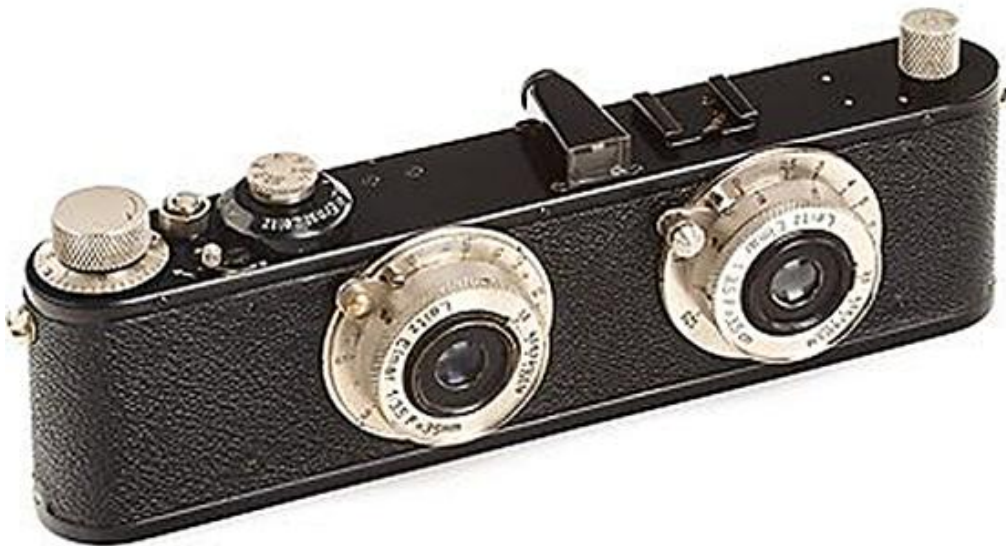
(1935). Original(acima) e Réplica (abaixo) da Doppel Stereo-Leica de Oskar Barnack como duas Elmar 3.5/3.5cm (níquel). Primeiro modelo em estereo construída para seu uso particular e algumas poucas encomendas.
