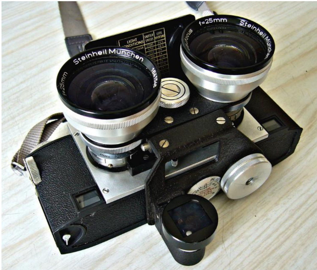
Câmara montada com adaptador Steinheil. Converte a objetiva de 35mm em 25mm (0.7x)
