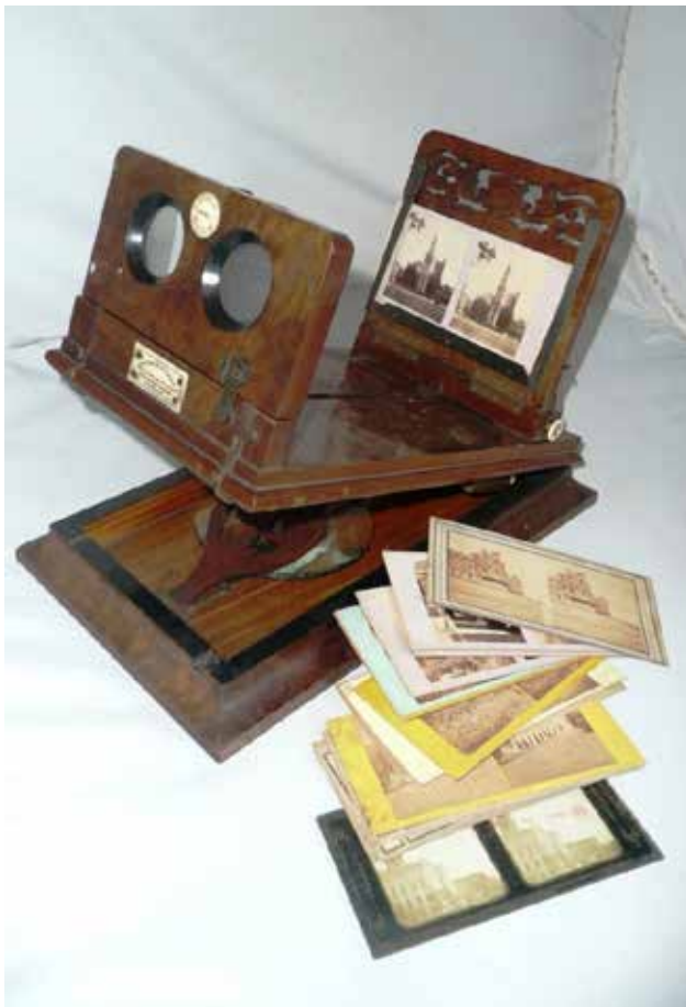
Visor estereoscópico de mesa em carvalho 'Rowsell's Patent Graphoscope' fabricado por Negretti & Zambra, sec XIX.
