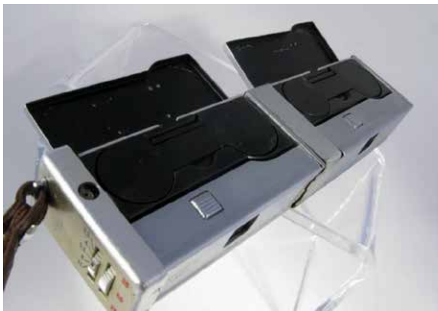
Modelo artesanal de câmara esteoscópica Kïiv 16 usando dois filmes Minolta 16
