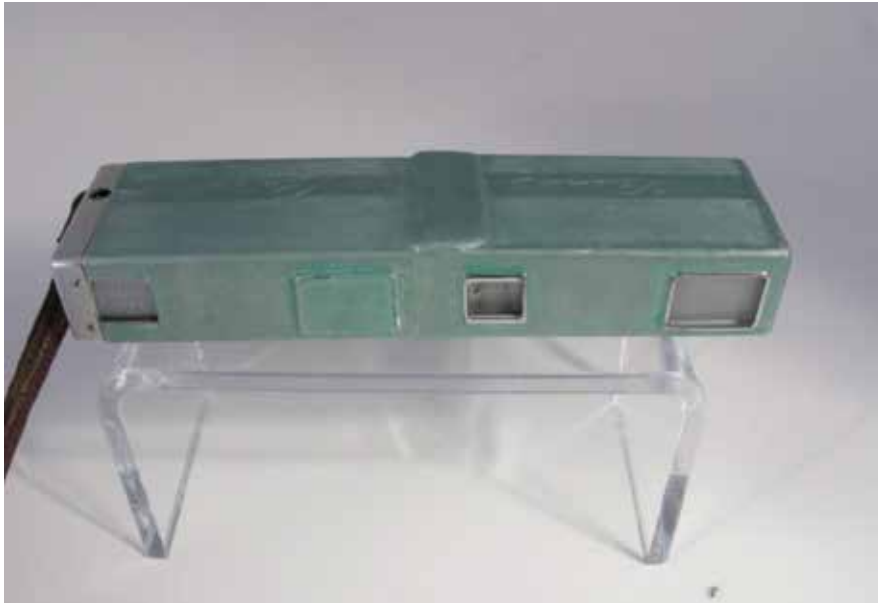
Modelo artesanal de câmara esteoscópica Kïiv 16 usando dois filmes Minolta 16
