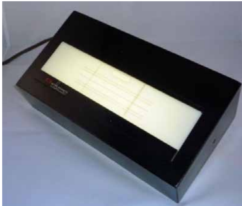
Illuminador auxiliar de montagem em duas imagens
