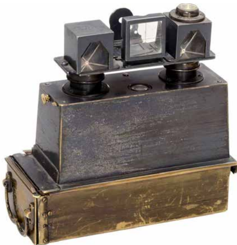
Vériascope com prisma de transposição
