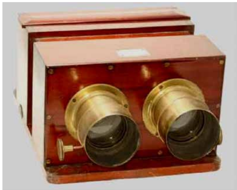
Negretti & Zambra 1853, Esta câmara pode operar com Daguerreótipos ou placas de vidro
