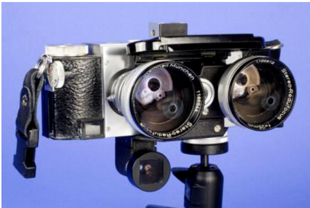
Câmara montada com adaptador Steinheil. Converte a objetiva de 35mm em 25mm (0.7x)
