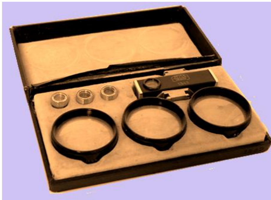
“Stereotar C” sem prismas de alargamento e pequena interpupilar para fotos a curta distância. Abaixo, “Contameter 1343”
