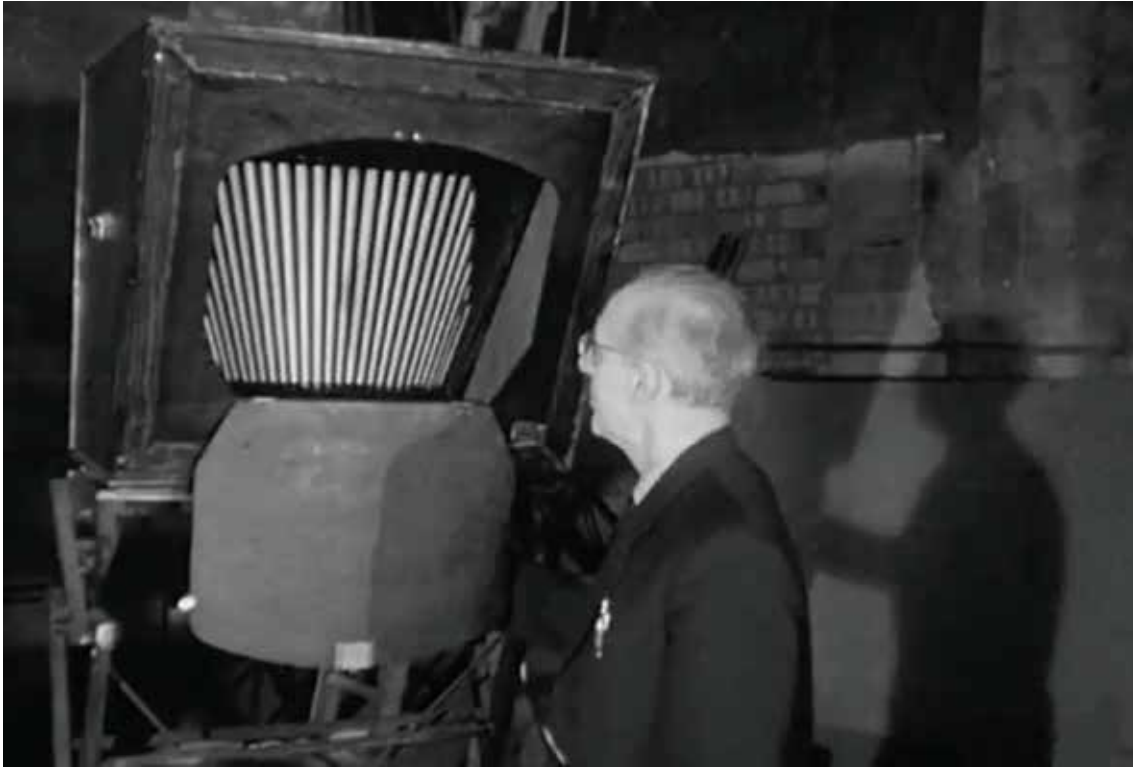
Barreira de paralaxe miniatura para demonstração do funcionamento
