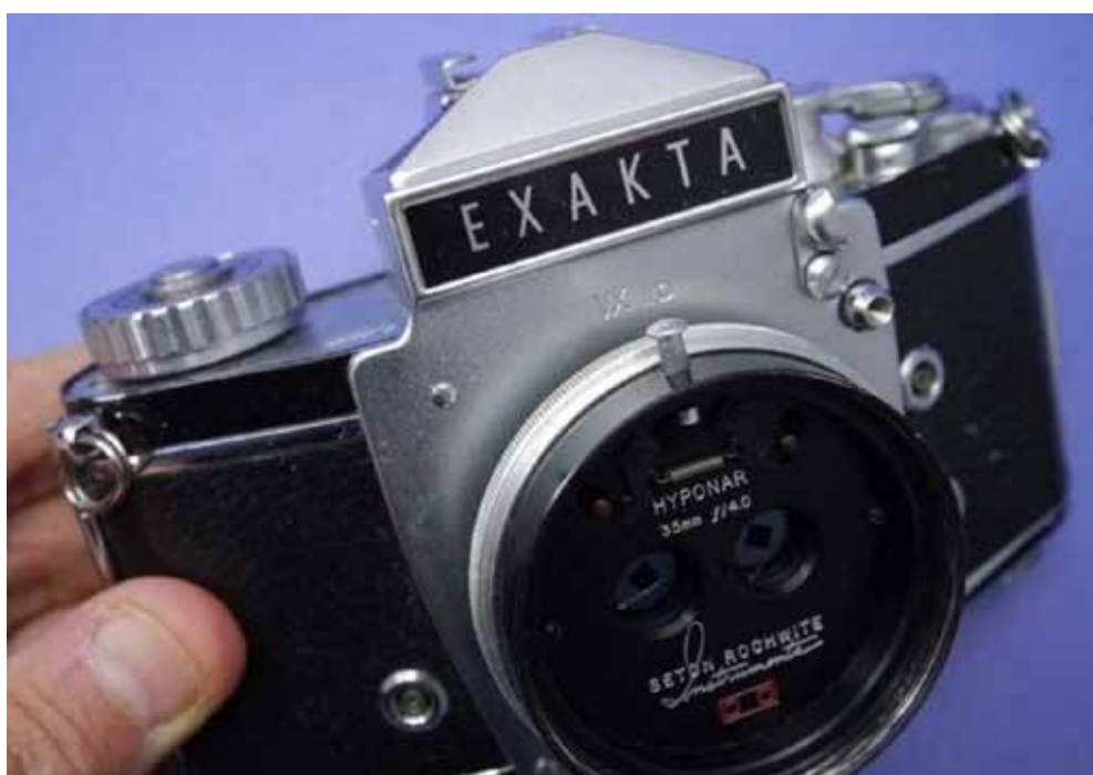
Hyponar com instruções do Kin-Dar Hypo-Stereo acoplado em Exakta VXIIa (2ª Série)
