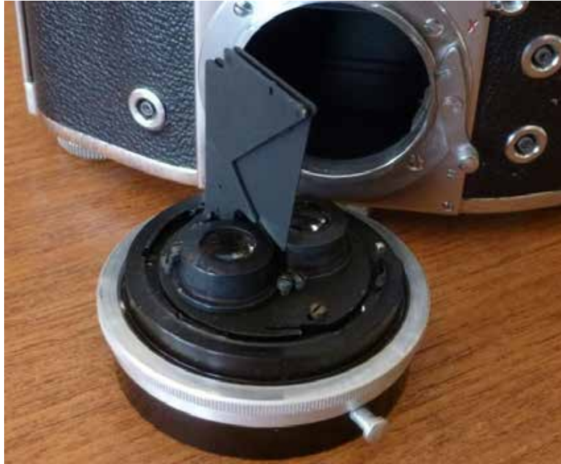
Visão da parte interna observando-se o septo móvel ao movimento do espelho
