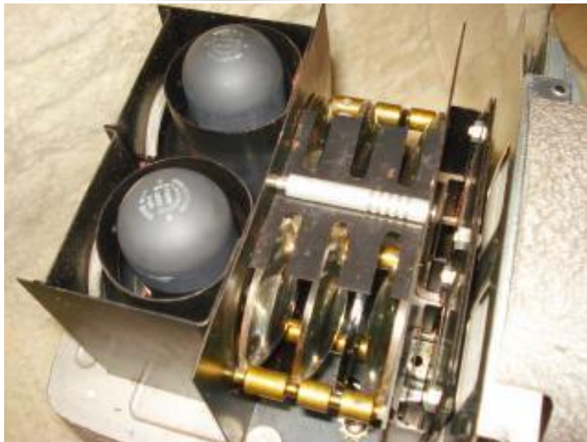
TDC Stereo Vivid 116. Unidade de iluminação e objetivas de 5 polegadas
