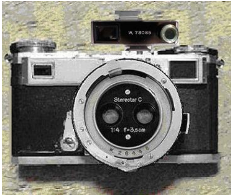
Contax II com Stereotar C e Contameter e lente de aproximação Proxar, mostrando o par de Tessares 4/35mm
