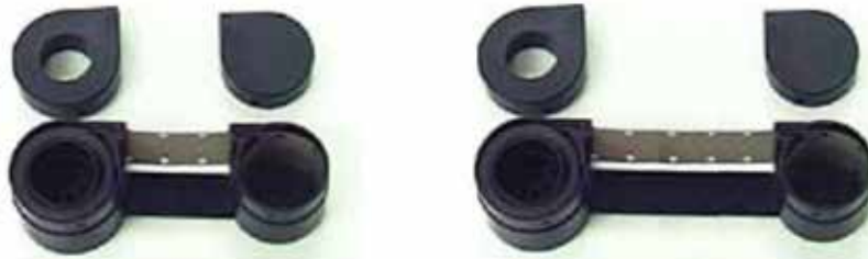
À esquerda filme original Minolta 16 à direita cartucho proposto para a nova câmara
