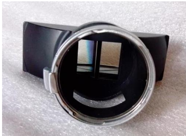
Prisma separador - Visão pelo lado da baioneta
