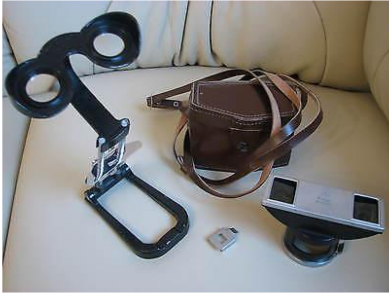
Prisma separador com Visor de mesa para cópias
