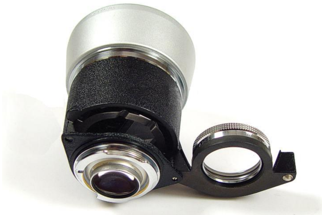
Nahr-Steritar em vista traseira vendo-se o elemento frontal da objetiva e a gaveta com o Proxar. Sem as Proxares o conjunto fotografa de 0,9m à oo (sem efeito estereoscópico de 2.5m à oo. E com as Proxares até 0,16m. O conjunto tem um elemento óptico idêntico ao componente frontal da Tessar e dois prismas de 20 dioptrias cada um.
