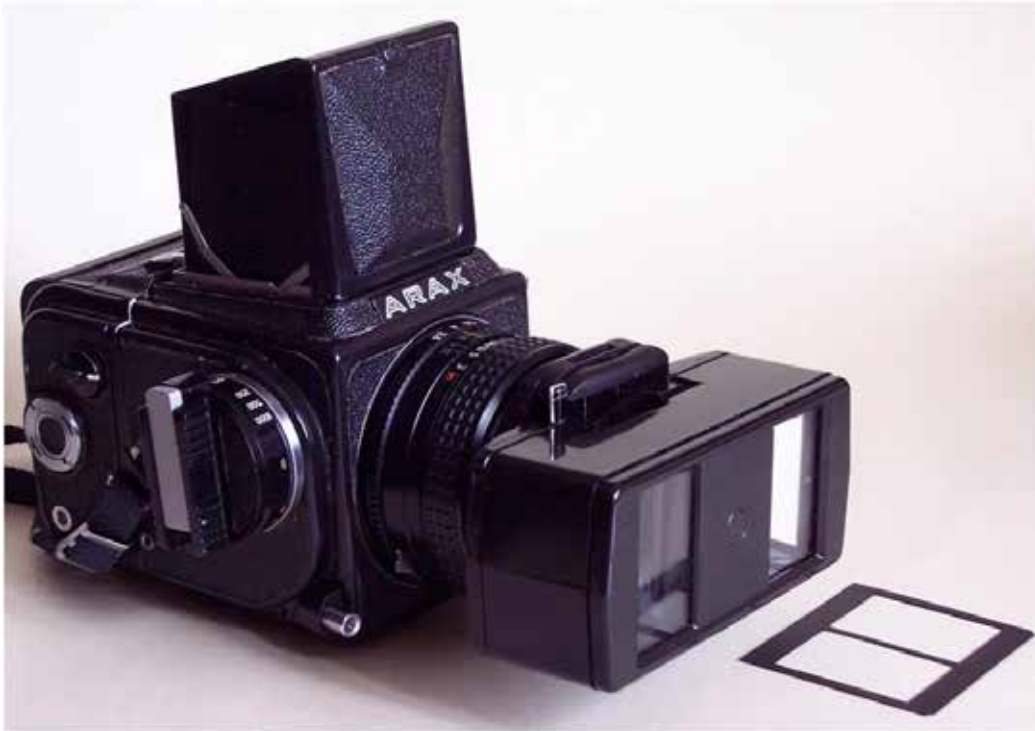
SKF-1 em conjunto com ARAX 80 (Kiev 88C) e magazine 4.5x6
