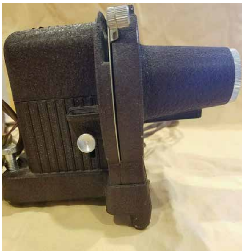
Projektor S-1. Detalhe do visor lateral de legendas impresso nos discos.
