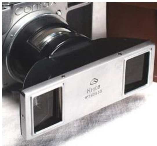
Kiev StereoNassadka adaptado em Contax II com Tessar 2.8/50mm
