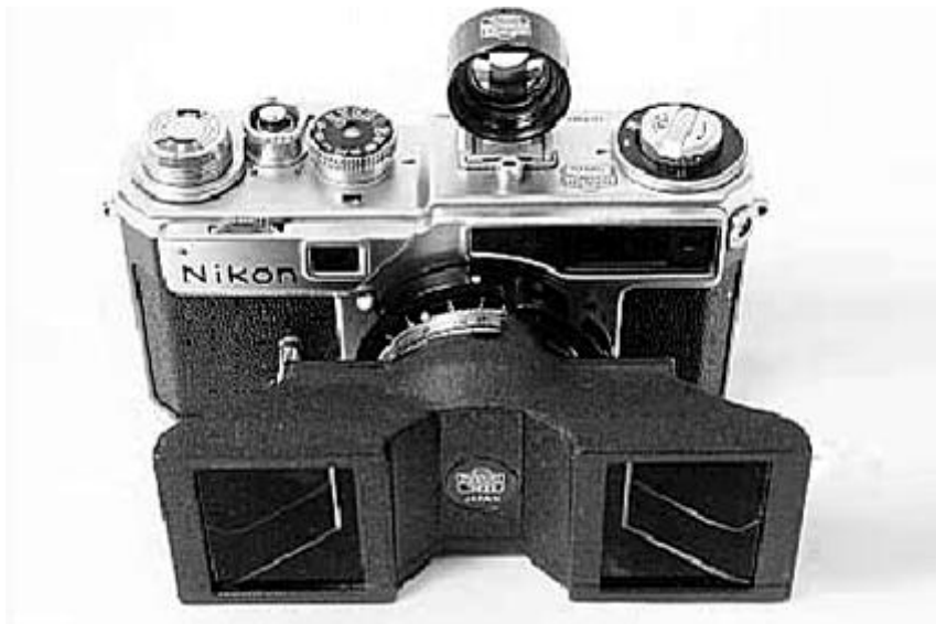
Stereo Nikkor em Nikon SP: Acima sem prisma: Abaixo com prisma
