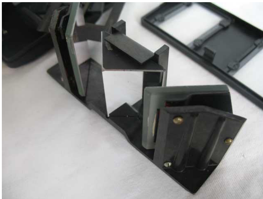
Unidade de prisma e espelhos montado em seu suporte de PTFE
