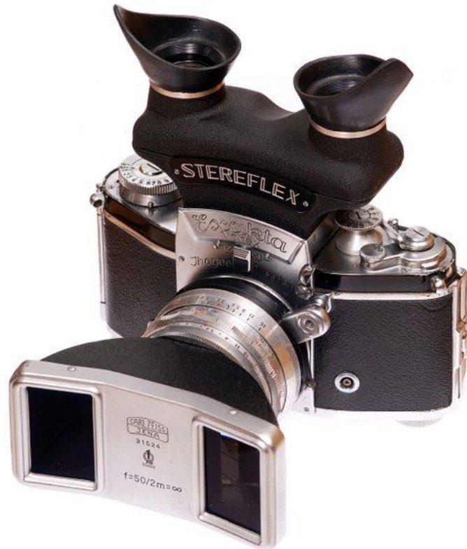
Stereflex com Stereovoratz sobre objetiva Meyer Domiplan em Exakta VX
