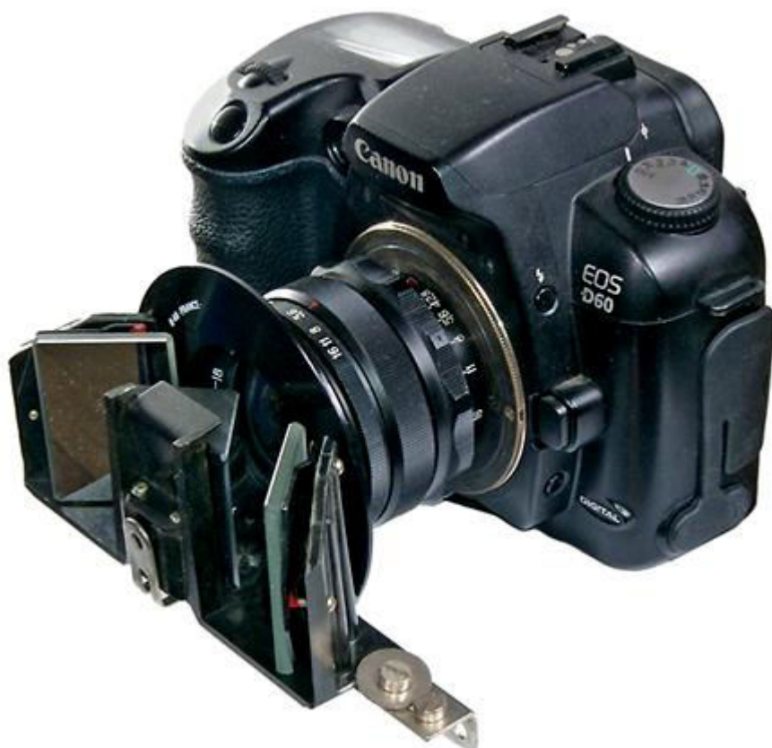
Canon EOS D60 com Mir-1 e sistema de espelhos sem proteção conforme Brat Luber.
