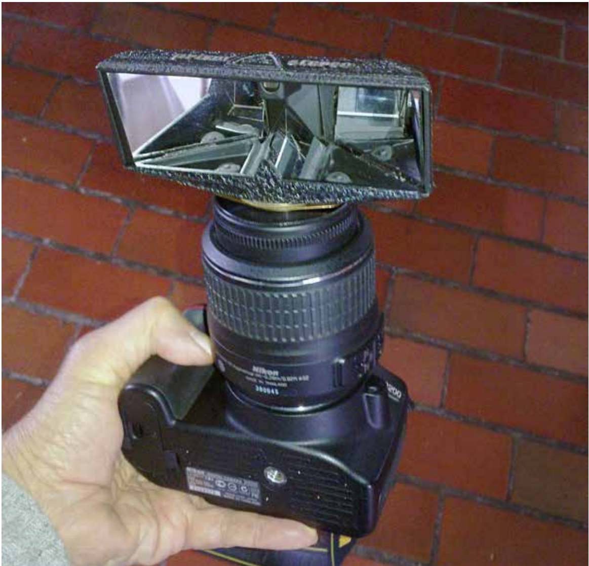
Substituição do prisma por espelhos e rotação dos espelhos secundários a 90°
