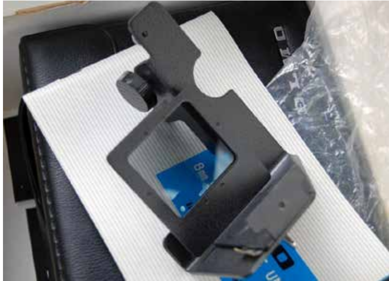
Adaptador para visor da câmara para ver imagem em posição correta
