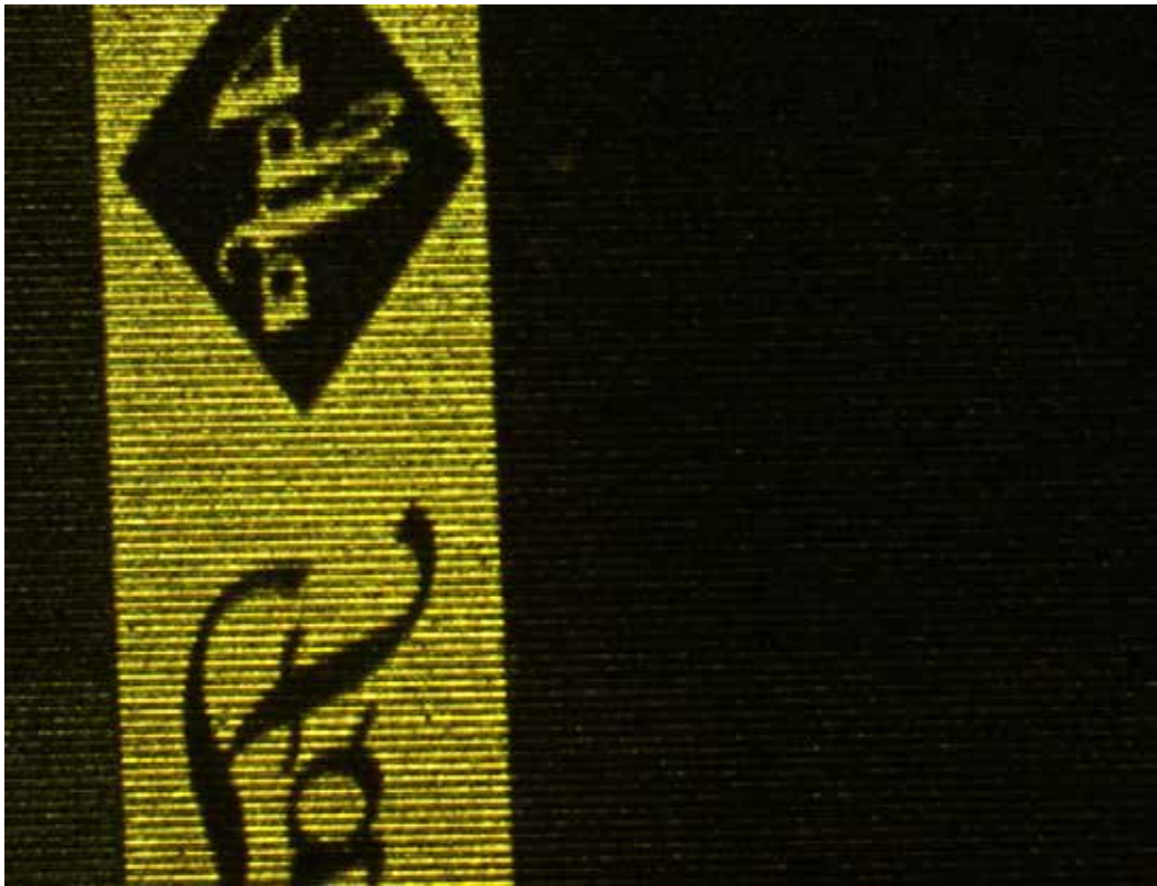
Superfície do Agfacolor Rasterfilm 5x fotomicrografia de Sylvana Konermann
