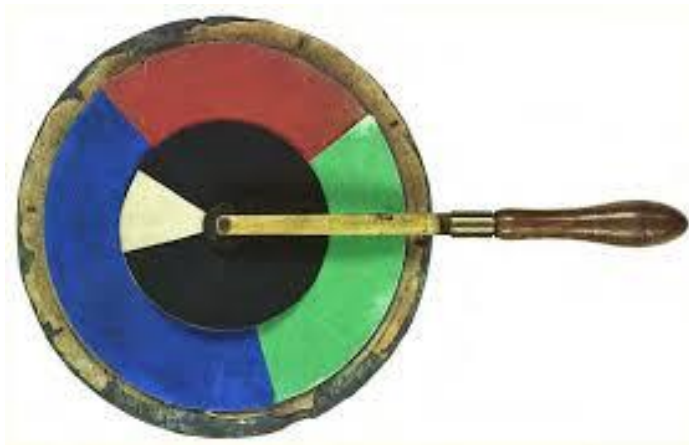
Disco de Maxwell para demonstrar e determinar a matriz RGB e o cinza neutro.
