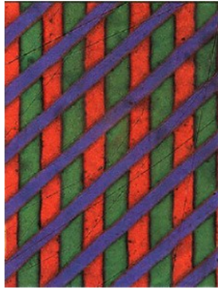
Desenho sobre a película usado no processo de Joly (Mosaico de Joly)
