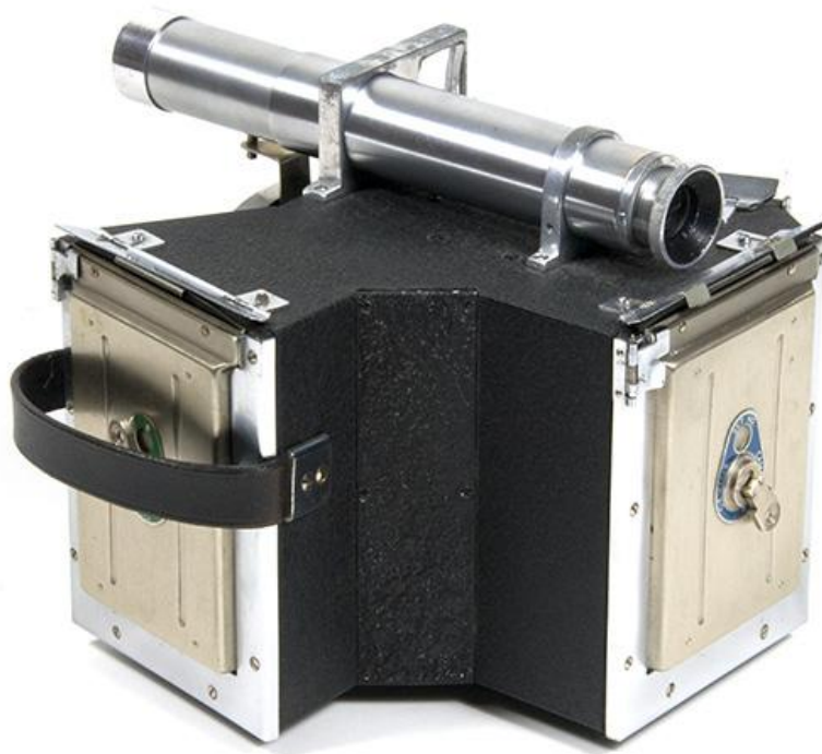
Na Devin Tri-Color Camera, o tubo promove a função de focalização.
