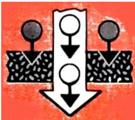
Revelador e agente de cor indo para a cópia
