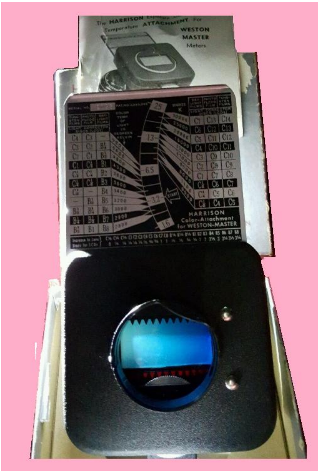
Vista interna com rodinha serrilhada, dentadura de controle e filtro azul.
