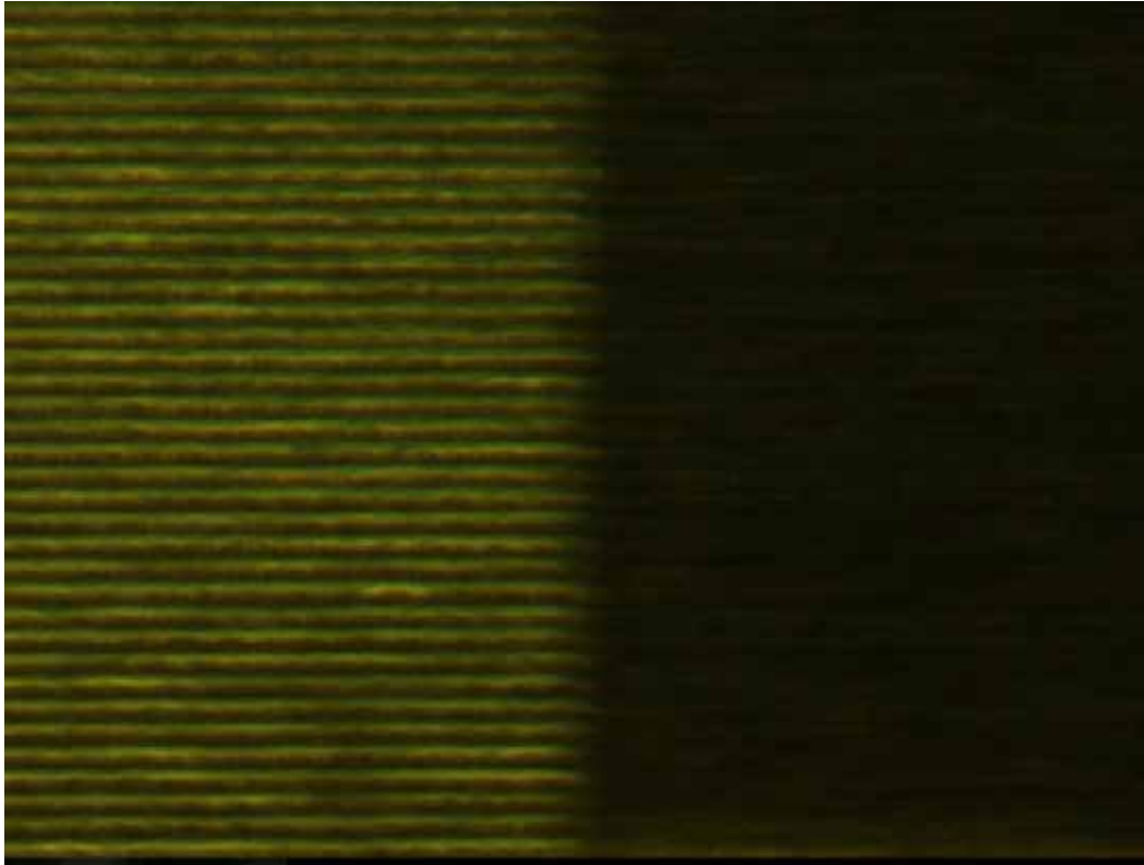
Superfície do Agfacolor Rasterfilm 10x fotomicrografia de Sylvana Konermann
