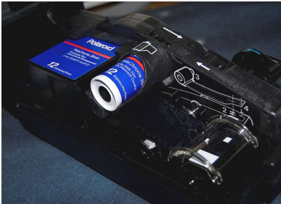
Vista interna do Polaroid AutoProcessor.
