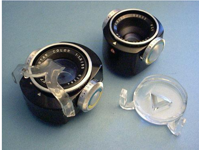
As duas versões Janpol com seus plásticos iluminadores da escala.
