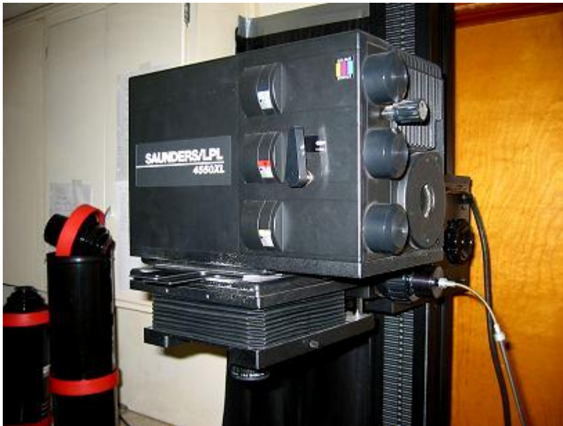
Aqui vemos a Cabeça de cores do ampliador Saunders LPL 4550XL 4x5. Azul, ciano e amarelo são comandados pelos discos (de cima para baixo).
