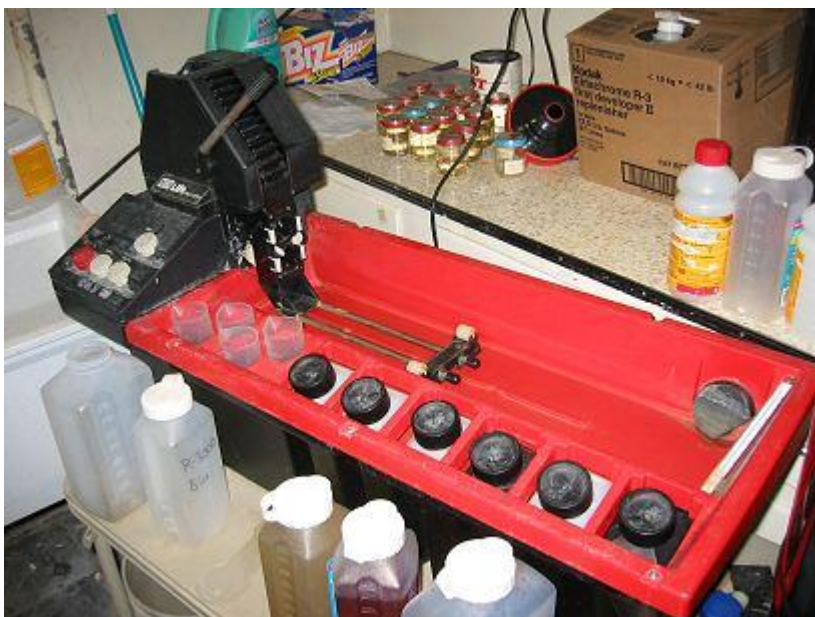
Processador Job CPA, com 6 frascos de químicos de 1L e 4 frascos graduados.
