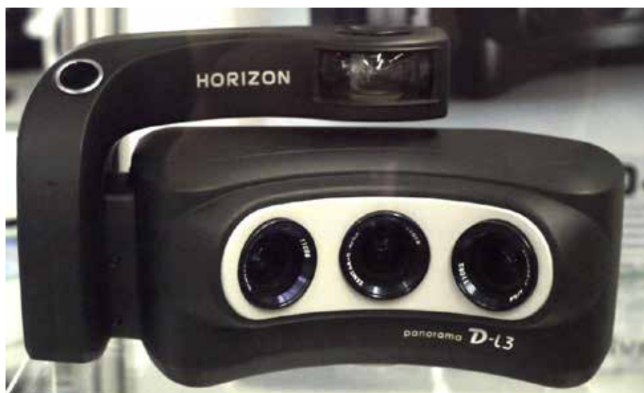
Horizon Panorama D-L3 (2010) panorama de 120° com três câmaras interligadas em um programa para fornecer uma só imagem.
