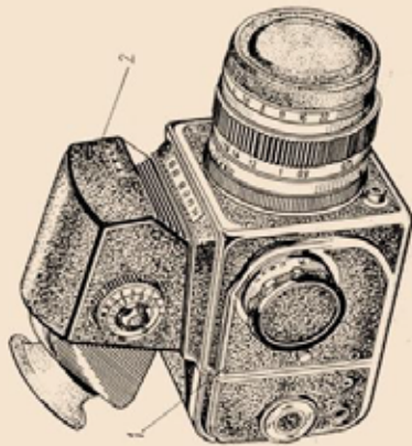
KIEV 88 TTL PRIMEIRA VISÃO 1- ACABAMENTO DO BOTÃO 2- PENTA PRISMA COM FOTÔMETRO
