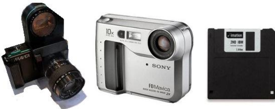
Sony Digital Mavica FD5 (1997). A FD5 foi a primeira digital a graver em floppy disks de 3.5”.
