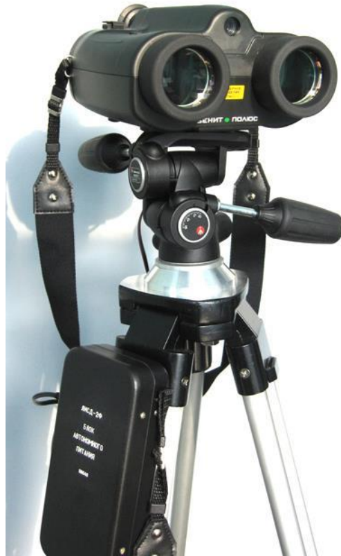
Zenit LISD-2F (2011) Câmera digital com radar de laser embutido. Destina-se a registrar a velocidade de veículos em movimento
