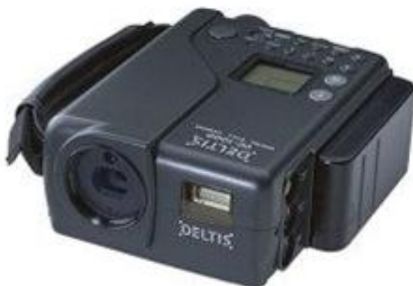
Olympus Deltis VC-1100 (1994). Incorpora um modem para transmissão de imagens através de aparelhos telefônicos convencionais.
