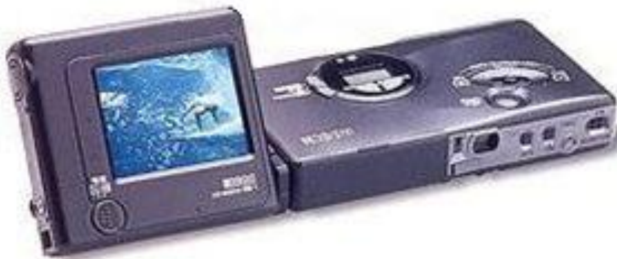
Ricoh RDC1 (1995). A Ricoh RDC1 foi a primeira câmara digital a ter opção de registo de vídeo.
