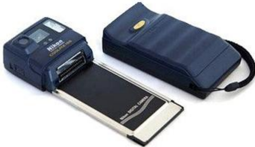
Nikon Coolpix 100 (1996). A câmara Nikon Coolpix pode ser conectada num laptop para transferência de imagens.
