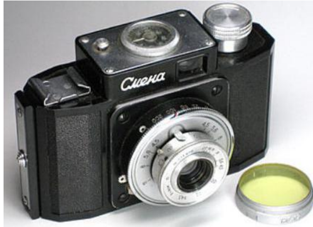
A Smena original de 1953 em plástico tinha o Vidor das Pionir (equivalente às FED e Leica) e traseira removível com carga cassete a cassete no padrão Contax.
