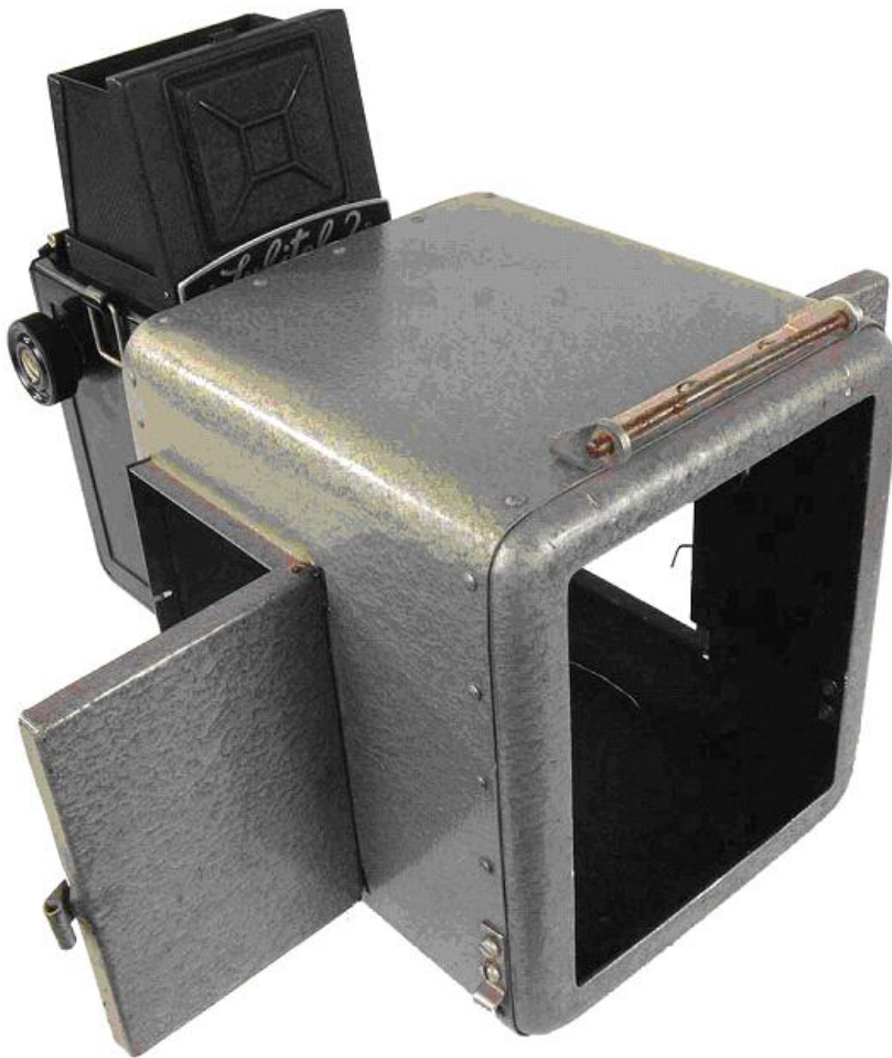
Lubitel 2 especialmente preparada para fotografar telas de osciloscópios. (1962)
