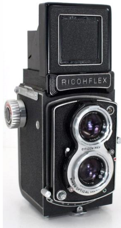
Mamiyaflex primeiro tipo com avanço por botão e armamento automático do obturador (1948) Ricohflex com focalização por duas alavancas laterais semelhante à Embirflex de 1939 da Checoslováquia.
