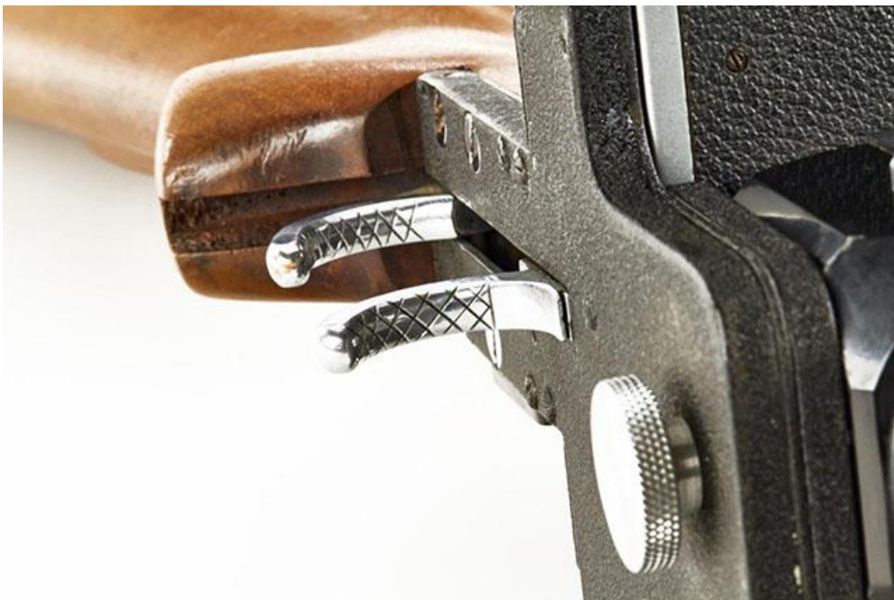
Detalhes do acoplamento do avanço no corpo da câmara e dos dois gatilhos.
