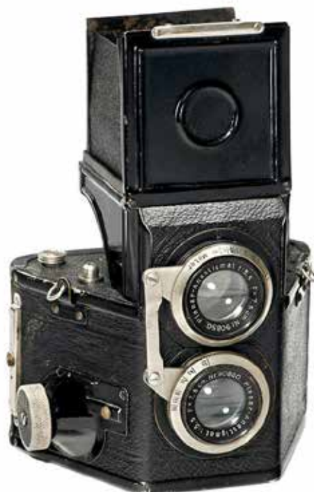
Karmaflex mod 2 1933 (Primeira plano focal dupla óptica 6x6) Alemanha
