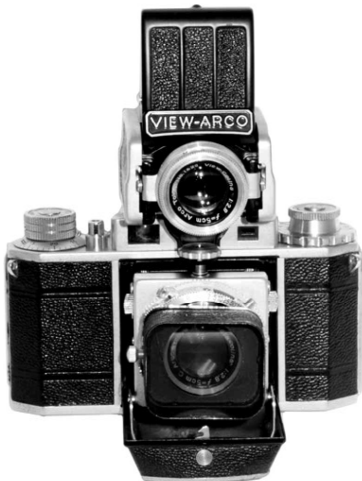
Arco 35 Conjunto de componentes montado e demonstração do movimento do visor.
